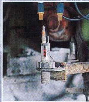
▲ Sonar-BERO mit Analogausgang meldet die Steinhöhe an die Steuerung.
