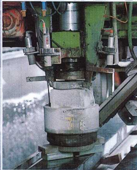
Die rechts und links angeordneten Sonar-BERO überprüfen die Position des Werkzeuges beim automatischen Werkzeugwechsel.
