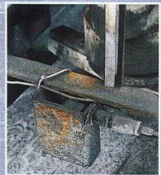
▲ Langlebig und robust; dieser Sonar-BERO erfüllt bereits seit 8 Jahren zuverlässig seine Aufgabe der Steinkantenerkennung.
