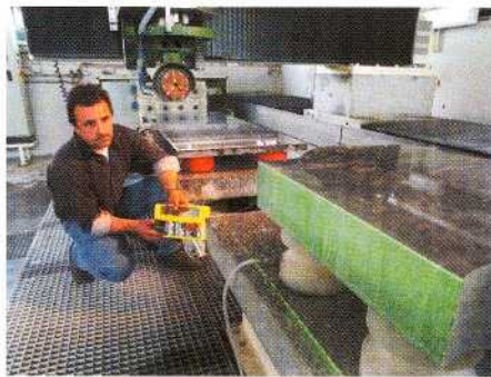
4: Der Teach-in-Vorgang zur Steinbearbeitung erfolgt lasergestützt
