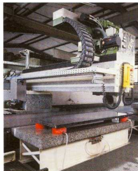
2: Durch Verwendung des hauseigenen Granits in der Stahl-Granit-Verbundkonstruktion des Maschinenbetts wird ein ruhiger und schwingungsarmer Betrieb der Schleifanlage möglich
