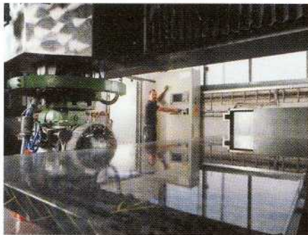
5: Die neue Walzenschleifanlage WSA-Mono bearbeitet alle vier Seiten der Natursteindenkmäler in einem voll-automatisierten Arbeitsgang
