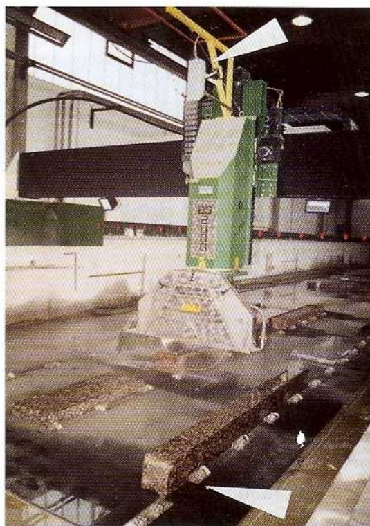
Bild 2: BS 2000 – oberer Pfeil: Scanner für die Tranchen und Halbzeug erfassung; unterer Pfeil: Werkstückanschlag als Bezugspunkt für die Maßeingabe
